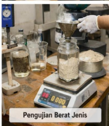
Pengujian Soil Sement Tanah Kapur Putih
