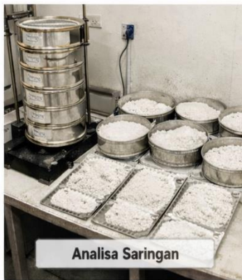
Pengujian Soil Sement Tanah Kapur Putih
