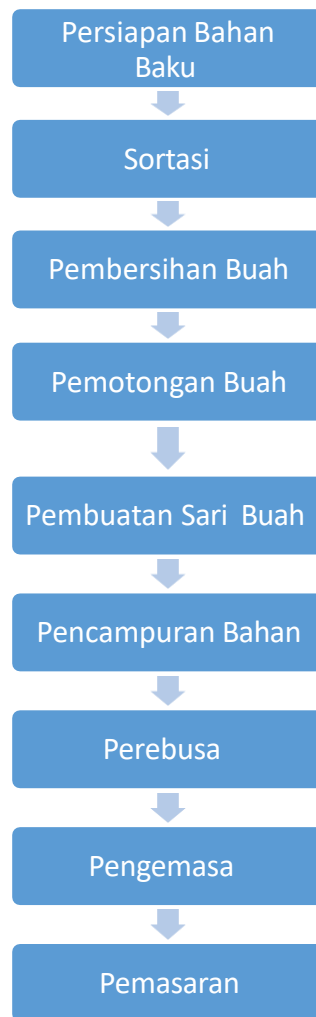
Gambar 15. Flowchart Proses Produksi Sirup Markisa Aurora
