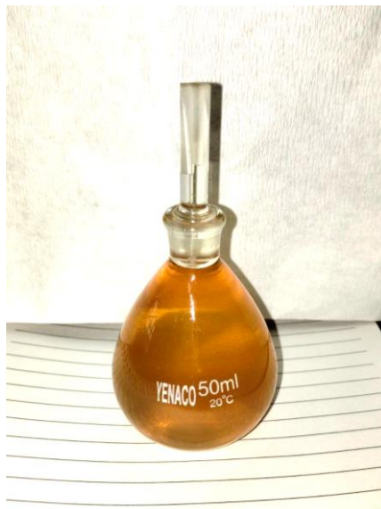
Gambar 18. Hasil parameter bobot jenis menggunakan piknometer (Sumber: Dokumentasi Pribadi)
