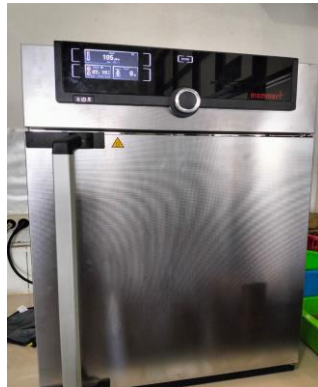
Gambar 4. Oven pengering (Memmert)
