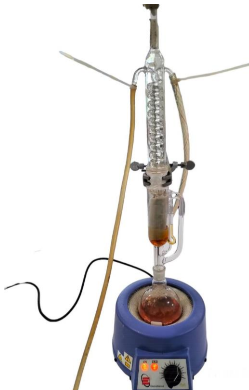
Gambar 7. Ekstraksi serbuk akar qust al hindi dengan metode soxhletasi
