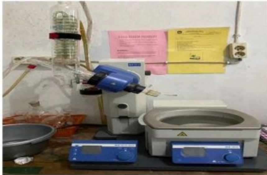
Gambar 12. Seperangkat Alat Rotavapor ( Ika® RV 10 basic ) (Sumber : Dokumen Pribadi)
