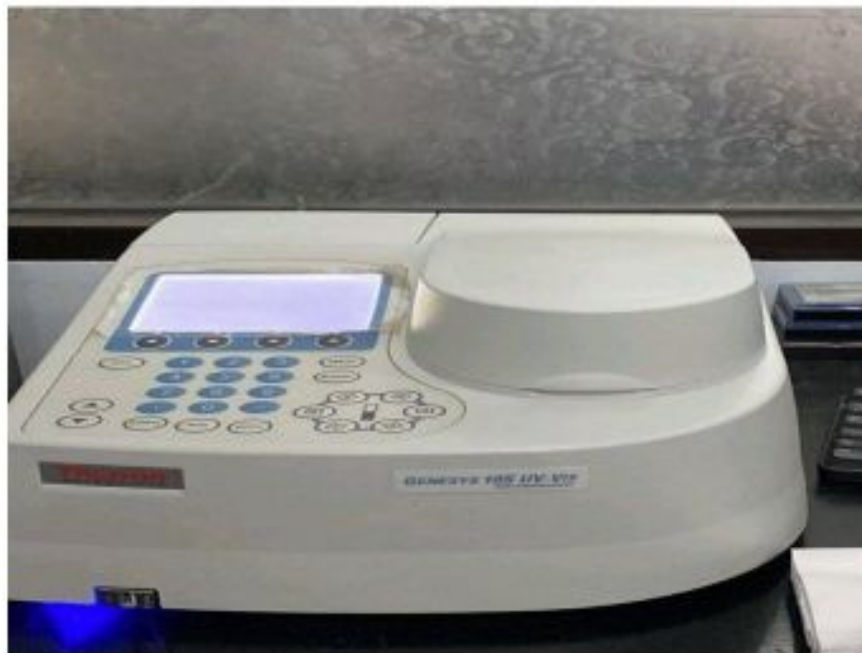
Gambar 13. Seperangkat Alat Spektrofotometer UV-Vis ( Genesys 10SUV-Vis ) (Sumber : Dokumen Pribadi)
