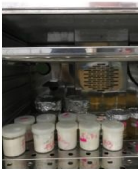
Gambar 34. Pengujian stabilitas pada climatic chamber
