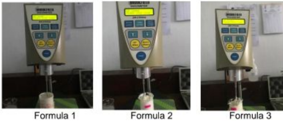
Gambar 33. Pengujian viskositas lotion setelah kondisi dipaksakan
