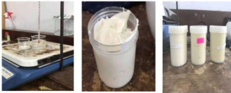
Gambar 22. Pengujian homogenitas lotion sebelum kondisi dipaksakan
