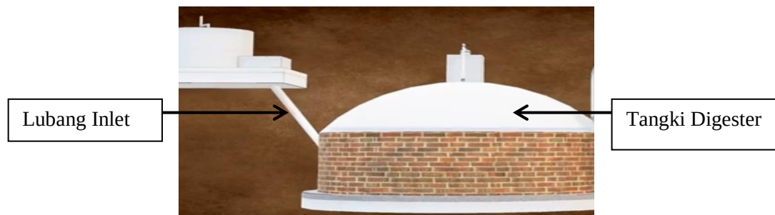
Gambar 4. Lubang Inlet dan Tangki Digester
