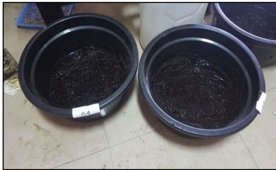
Gambar 4. Proses Perendaman Serat Ijuk Diameter 0.3 mm dengan Air Laut
