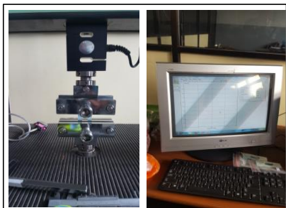
Gambar 5. Set Up Uji Tarik Serat Tunggal
