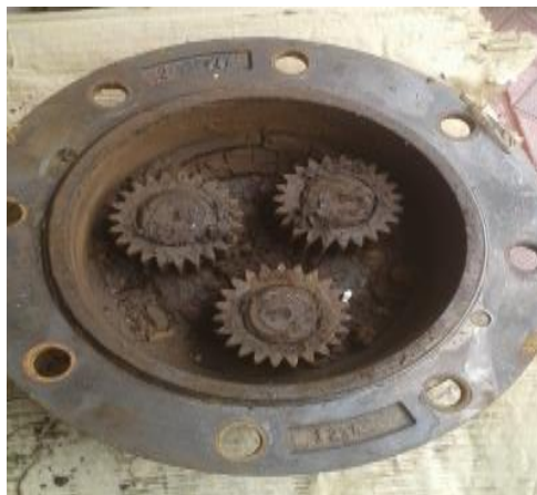
Gambar 5. Kondisi Carrier Planet Gear yang terlepas
