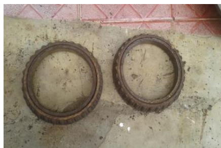
Gambar 7. komponen mengalami korosi (berkarat)
