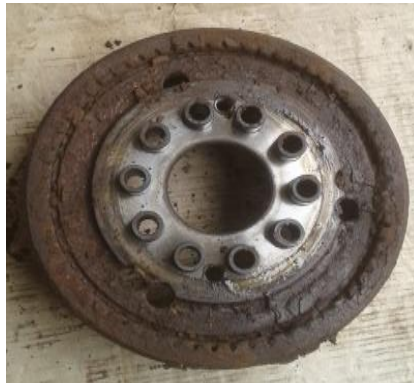
Gambar 9. komponen yang mengalami Sludge
