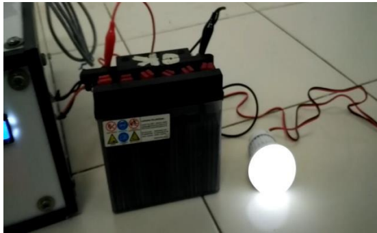
Gambar 8. Kondisi lampu masih menyala pada temperature di bawah 600 Celcius
