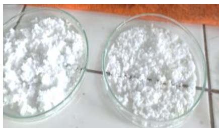
Gambar 2. Tawas yang dihasilkan dari limbah serbuk aluminium
