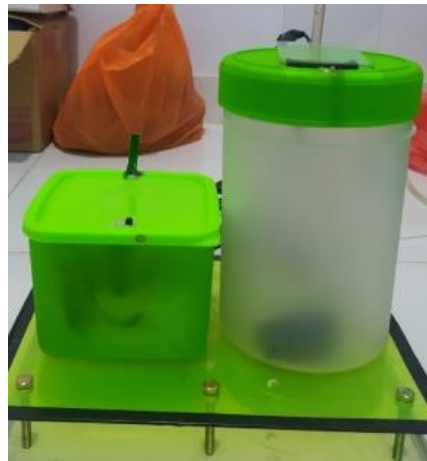
Gambar 2. Tampilan Handsanitizer Otomatis Dengan Notifikasi Melalui SMS
