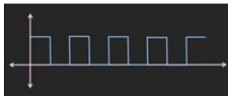
Gambar 6. Bentuk gelombang multivibrator astabil
