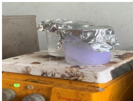
Gambar 9. Proses pemanasan benang wol untuk pembebasan lemak(dokumentasi pribadi)
