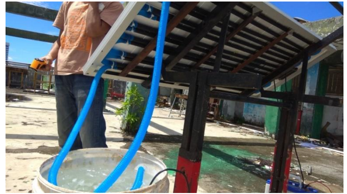
Gambar 4 Pengukuran Panel Surya Menggunakan Pendingin
