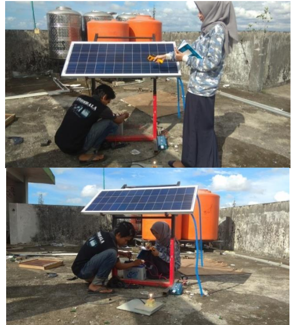
Gambar 3. Pengukuran Temperatur Panel Surya Tanpa Pendingin
