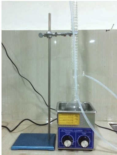
(a) Proses reaksi degradasi gliserol dengan gelombang ultrasonik (tampak depan)
