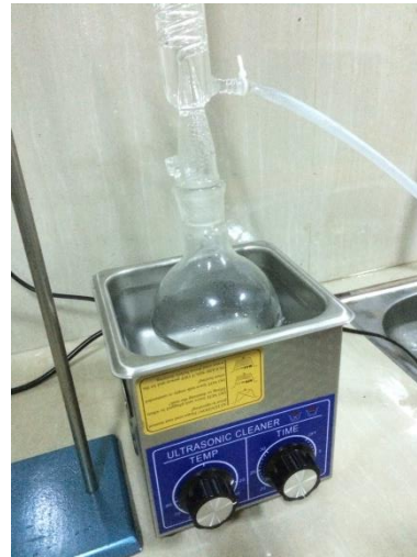
(b) Proses reaksi degradasi gliserol dengan gelombang ultrasonik (tampak atas)
