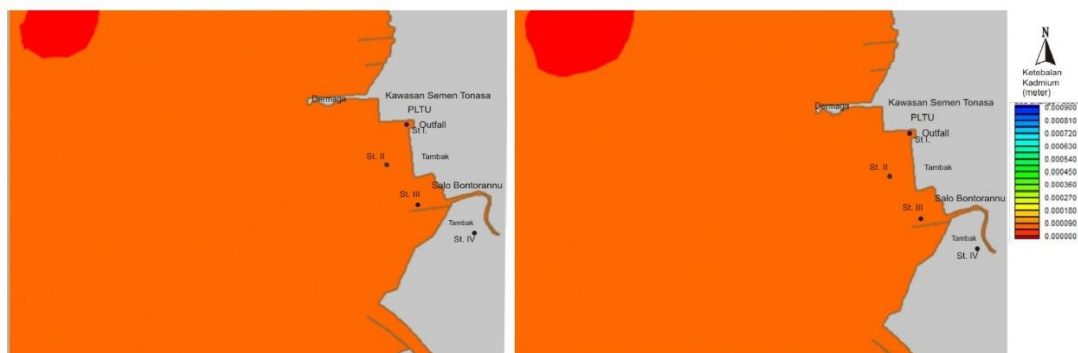
Gambar 5. Pola distribusi Pb (kiri) dan Cd (kanan) di sedimen pada t = 24 jam. Konsentrasi Pb-Cd ditunjukkan dengan gradasi warna, nilainya 0,0000 – 0,0009 ppm.
