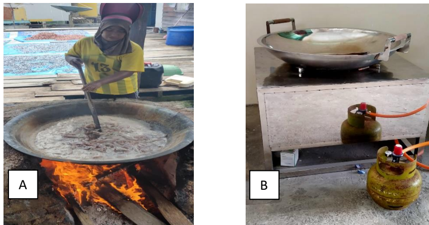
Gambar 1. Perebus cumi berbahan logam (A) dan stainless steel berspesifikasi food grade (B)
