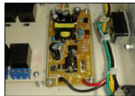
Fig. 4. Power suplay circuit with output 12 volt and 5 volt
