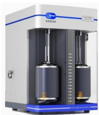
Gambar 2.42. (kiri) Salah satu alat BET yang digunakan untuk menentukan luas permukaan material yang berukuran sangat kecil (app-one.com.cn). Dasar kerja alat ini adalah menghitung jumlah atom atau molekul gas yang menempel dan menutupi permukaan material (kanan). Karena luas satu atom atau molekul sudah ada datanya maka luas permukaan material dapat ditentukan
