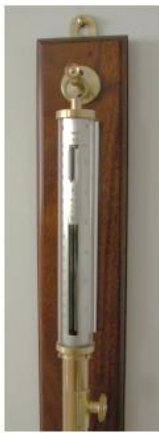
Gambar 2.23. (kiri) Contoh barometer air raksa (patrickmarney.co.uk). (kanan) Skema barometer air raksa. Terdapat wadah penampungan air raksa dan pipa kecil yang dicelupkan terbalik secara vertikal (bagian terbuka tercelup di dalam air raksa dan bagian tertutup di sisi atas). Pipa divakumkan. Air raksa dalam wadah ditekan oleh udara luar sehingga terdesak naik sepanjang pipa
