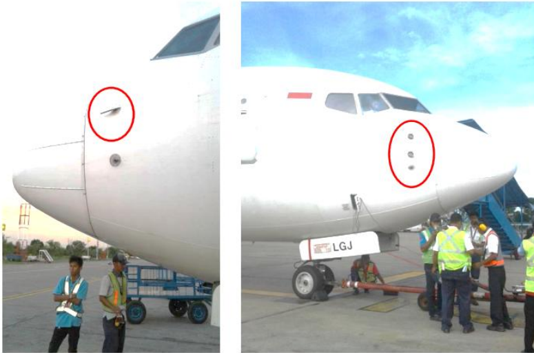
Gambar 3.27. Tabung pitot pada dua sisi body depan pesawat Boeing seri 737-800 Next Generation. Foto diambil di Bandara Husein Sastranegara, Bandung dan Bandara Syamsuddin Noor, Banjarmasin
