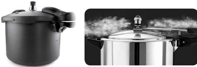
Gambar 2.37. (kiri) Contoh presto dan (kanan) jika tekanan uap di dalam presto maka pembeban di bagian penutup sedikit terangkat sehingga keluar semburan uap sehingga tekanan kembali turun. Mekanisme ini mengontrol agar tekanan dalam presto memiliki batas maksimum
