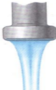
Gambar 3.16 Air yang mengalir turun dari suatu keran mengalami perubahan luas penampang. Makin ke bawah, penampang air makin kecil.
