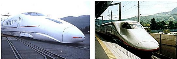
Gambar 3.36. Rancangan bagian depan kereta supercepat Shinkansen untuk mengurangi gaya gesekan dan meningkatkan kestabilan gerak
