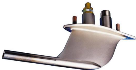
Gambar 3.28. Contoh desain tabung pitot yang dipasang ke pesawat (sumber gambar: aviation.stackexchange.com)
