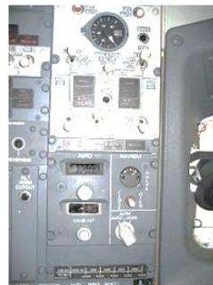
Gambar 2.45. (kiri) Kabin pesawat adalah ruang tertutup dan tidak ada udara yang dapat keluar masuk secara bebas ( travel.detik.com ). Udara dapat keluar dan masuk melalui sistem pengontrolan sehingga tekanan udara dalam kabin dapat dibuat tetap. Saat pesawat menjelajah, tekanan udara dalam kabin jauh lebih tinggi daripada tekanan udara luar. (kanan) Pressurization controls yang dipasang di pesawat Boeing-737 Next Generation ( en.wikipedia.org ). Alat ini yang mengukur tekanan udara dalam kabin dan memerintahkan tambahan supply udara jika tekanan udara dalam kabin sedikit turun
