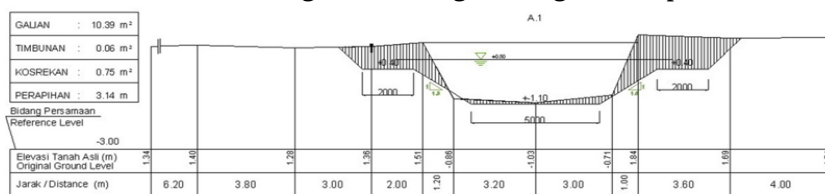
Gambar 6. Potongan melintang desain saluran primer
