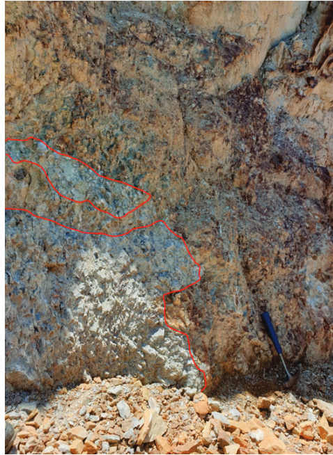
Abb. 5. Stark deformierte unvererzte Prähilbrekzie wird durch eine metasomatische Front von rechts her umgewandelt (Foto: F. MELCHER).
