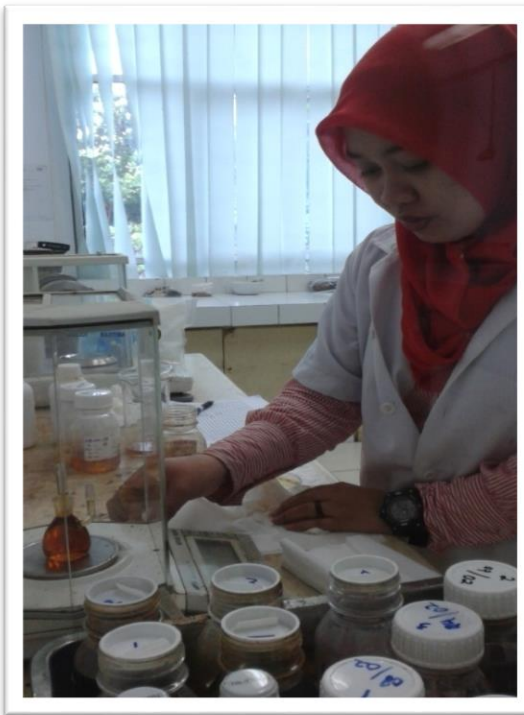
Gambar LB-13. Uji massa jenis (bj) pada produk asap cair
