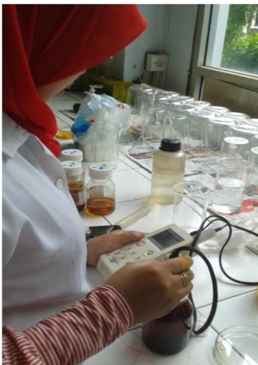
Gambar LB-11. Uji pH pada produk asap cair
