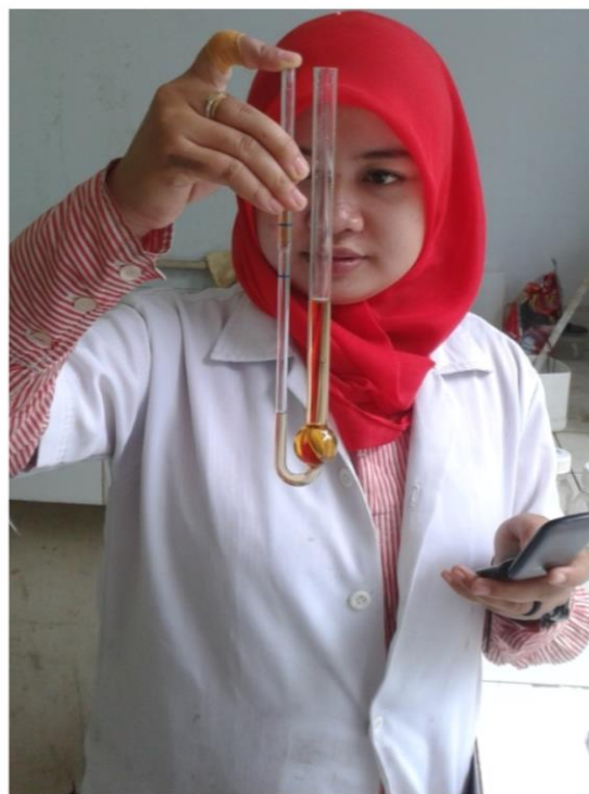
Gambar LB-12. Uji viskositas (kekentalan) pada produk asap cair
