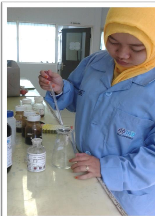
Gambar LB-15. Proses penambahan indikator pp sampel pada uji kandungan asam asetat
