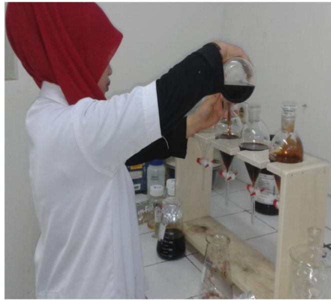
Gambar LB-7. Proses pemisahan sampel di corong pisah
