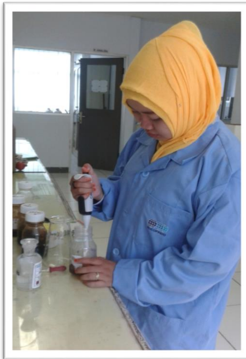
Gambar LB-14. Proses pemipetan sampel pada uji kandungan asam Asetat
