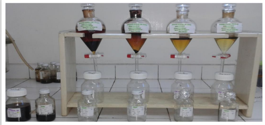
Gambar LB-8. Sampel asap cair sebelum di pisahkan di corong pisah
