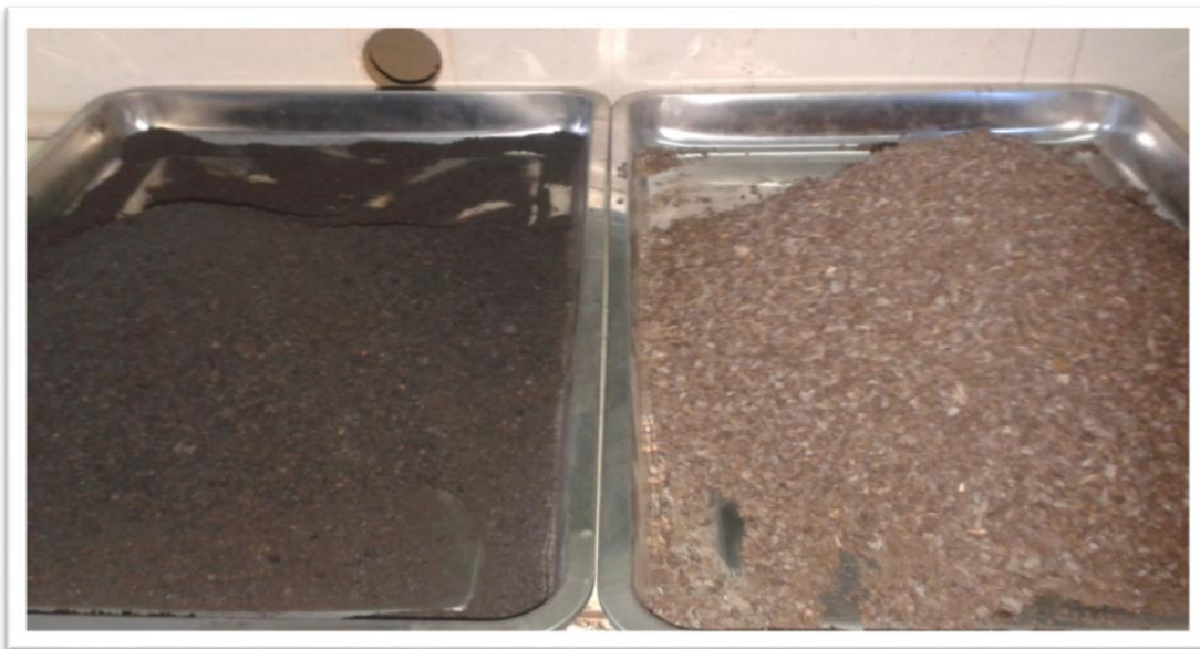
Gambar LB-4. Sampel cangkang sawit mesh 6 dan Batubara mesh 6 yang telah di hancurkan dengan alat crusher
