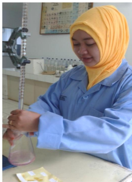
Gambar LB-16. Proses titrasi sampel pada uji kandungan asam Asetat
