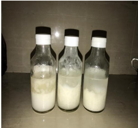
Gambar C.7 Emulsi VCO : Air (Tidak Stabil)
