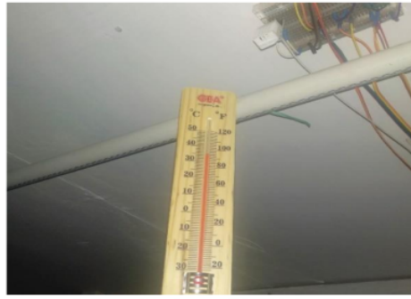
Gambar 5. Pengujian Sensor DHT22 dan Termometer
