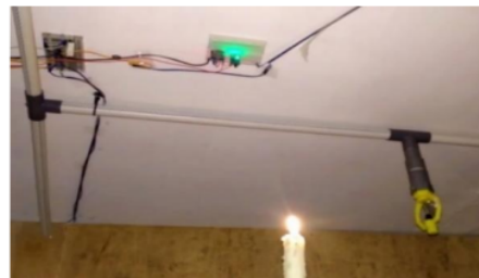
Gambar 3. Pengujian Sensor Api
