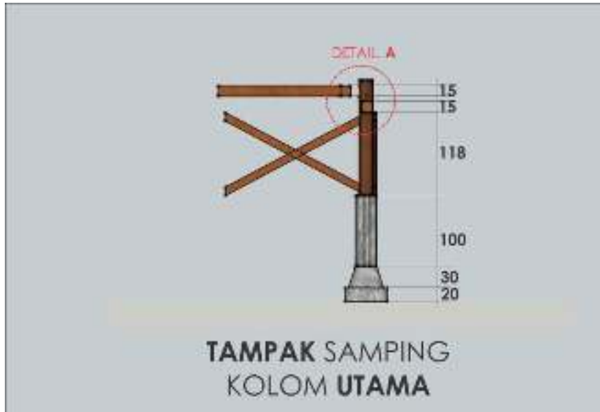
Gambar 22. Detail Struktur Bawah Antar Kolom Rumah Panggung Sumber : Hasil Analisis, 2016
